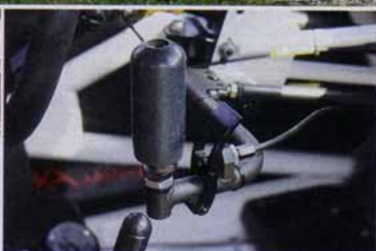
Das Getriebe wird per Krückstockschaltung befehligt. Das Hebelchen ist die Arretierung für den Retourgang
